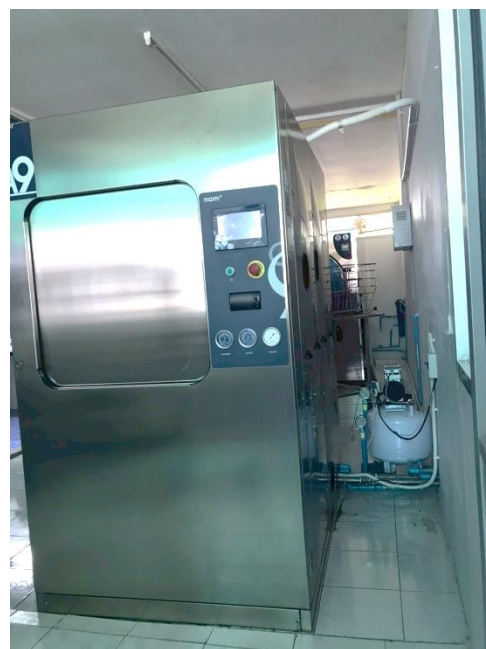
ภาพ เครื่องนึ่งอุปกรณ์ทางการแพทย์หน่วยจ่ายกลางสำหรับส่งน้ำเข้าและระบายน้ำออก
